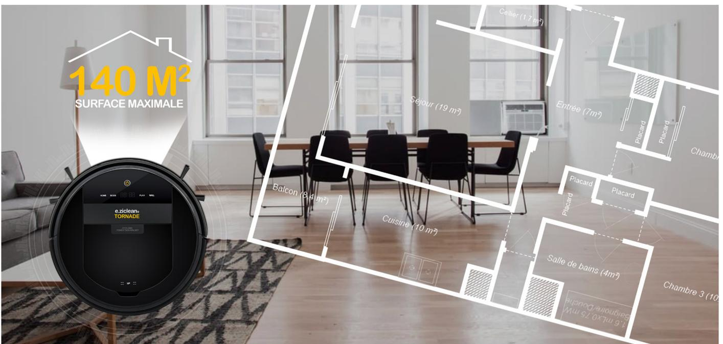
Ses 3 capteurs ultrasons et 19 détecteurs infrarouges frontaux lui permettent de détecter les obstacles dans la pièce (meubles, canapés, chaises...) et de nettoyer au plus près sans les percuter.
