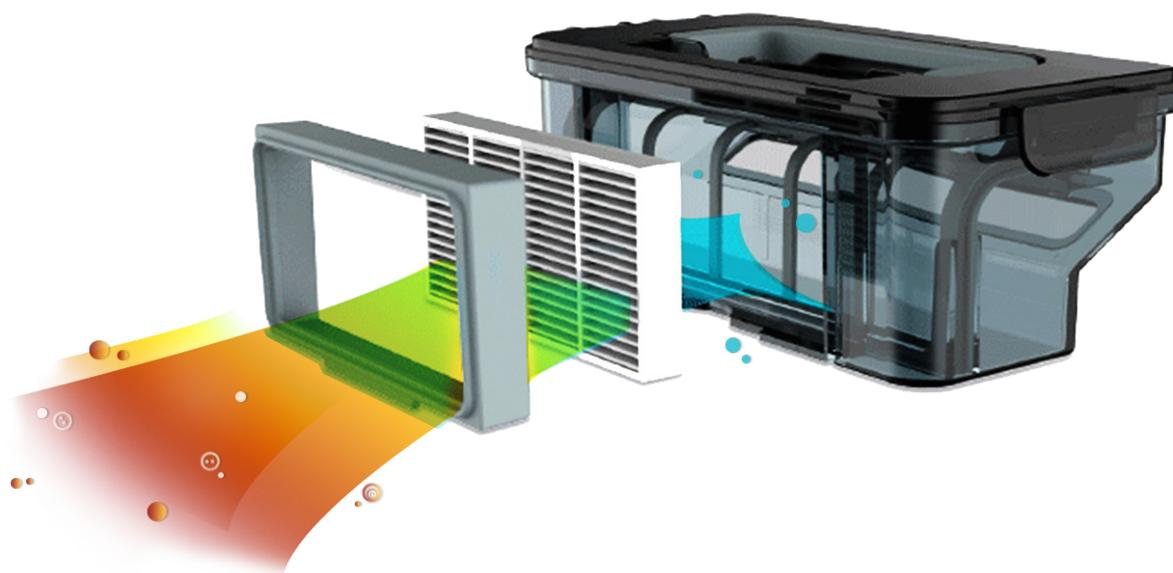
e.ziclean TORNADE V2 propose une vidange du bac par le dessus, évitant tout rejet de poussières lorsque celui-ci est plein. Il est également équipé d'un volet anti-retour de particules, et d'une poignée de transport. Son filtre HEPA 11 emprisonne efficacement les micro-poussières et allergènes présents dans l'air. D'une capacité de 500mL, il suffira de le vider une fois par semaine seulement, à raison de 2 à 3 utilisations par semaine de votre robot.
