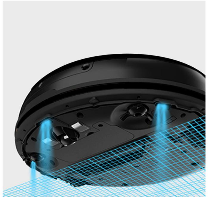
Grâce aux 10 détecteurs de vide situés sous le robot, e.ziclean® TORNADE V2 ne tombe pas dans les escaliers et s'adapte aux changements de niveau du sol jusqu'à 2 cms. Enregistrant son parcours en temps réel, il adapte automatiquement son schéma de navigation pour anticiper et contourner les obstacles qu'il a déjà rencontré.
