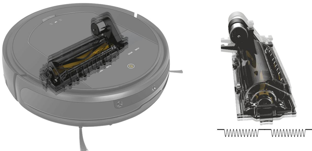
Sa tête de nettoyage est flottante, ce qui permet à sa puissante brosse d'épouser les irrégularités des différentes surfaces. Toujours au plus près des sols, elle permet de ramasser et aspirer avec une constante efficacité sur les parquets, carrelages ainsi que les moquettes et tapis. Sa brosse centrale est également composée de 2 matériaux : des filaments souples en nylon pour collecter les poussières fines et des lamelles caoutchouc pour les débris plus épais, les poils et cheveux.
